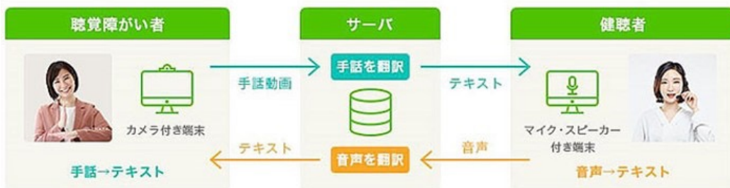
図1: SureTalkの構成。AIによって聴覚障がい者の手話を手話をテキストに、健聴者の音声はテキストに変換してコミュニケーションを支援する。
